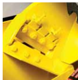
CUTTING DISC TS INDUSTRIE™ équipé de 2 couteaux réglables pour des plaquettes calibrées.
